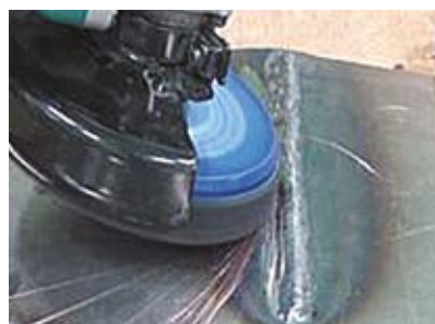
Odstraňování barevných defektů způsobených svařováním
