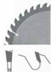
ATB zuby se střídavým sklonem
